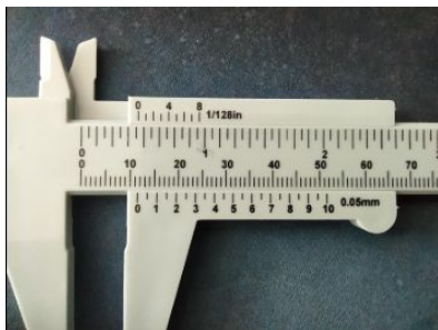
Standard Caliper: \pm 0.05 \text{ mm} U_r = 0.25\%
