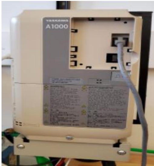
Fig. 7. Parameter Yaskawa A1000 Drive
